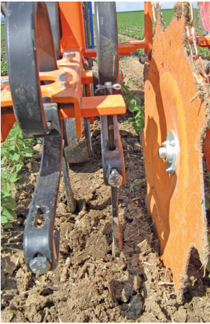
Abb. 5: Mechanische Unkrautbekämpfung – Einsatz von Hackscharen in Soja. Die Bleche schützen die Kulturpflanzen während der Arbeit.
